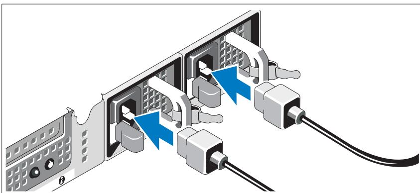
Conecte los cables de alimentación al sistema.
