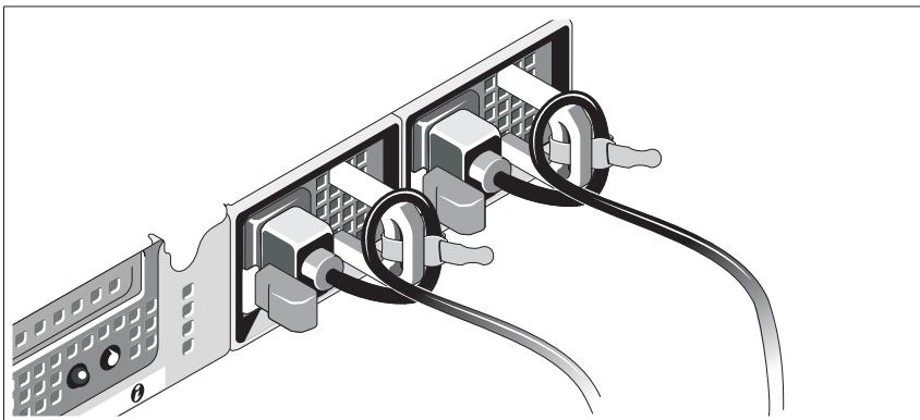
Dobre o(s) cabo(s) de alimentação do sistema formando um laço, conforme mostrado na figura, e prenda-o com a tira fornecida. Conecte a outra extremidade do(s) cabo(s) de alimentação a uma tomada elétrica aterrada ou a uma fonte de energia separada, por exemplo, uma UPS (Uninterruptible Power Supply [fonte de alimentação ininterrupta]) ou uma PDU (Power Distribution Unit [unidade de distribuição de energia]).
