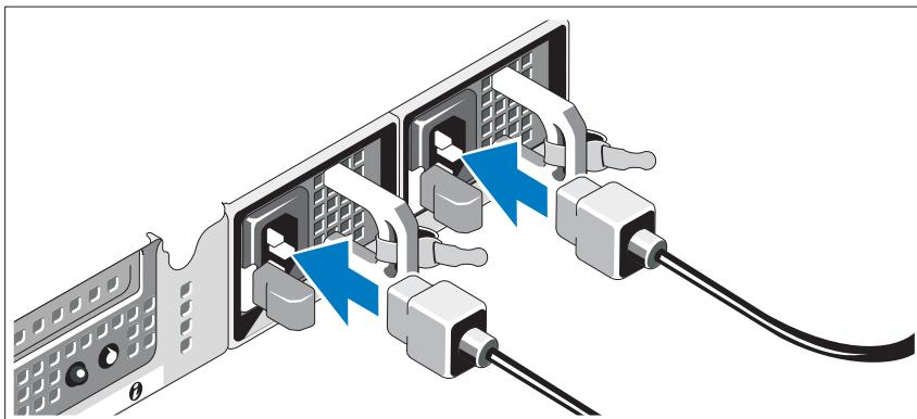
Conecte o(s) cabos de alimentação ao sistema.
